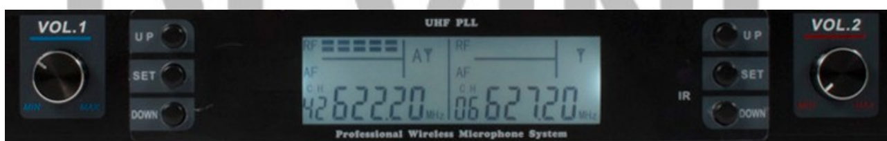
Indication du canal et de la fréquence sur le récepteur WMD-168MKII.
