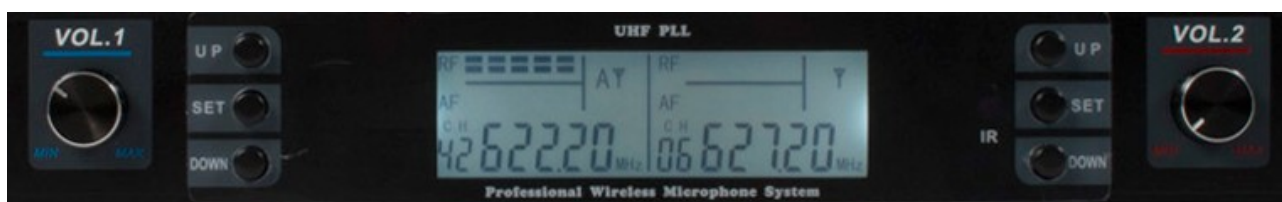
Kanal und Frequenzanzeige auf dem WMD-168MKII-Empfänger.
