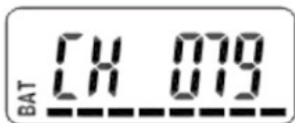
Kanalanzeige auf dem Bodypack-Sender.
